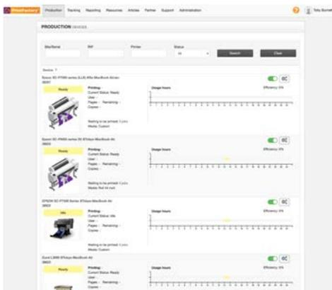
**#2 Le travail de contrôle** en amont se fait automatiquement sans qu'il soit nécessaire de vérifier manuellement chaque fichier. Au cours du processus d'ingestion des fichiers, WorkFlow de **PrintFactory** interrogera le fichier d'illustration et comparera son contenu à un profil de contrôle en amont. En fonction des paramètres du WorkFlow, le système tentera de corriger les défauts ou déplacera les fichiers dans un dossier pour un contrôle manuel.
